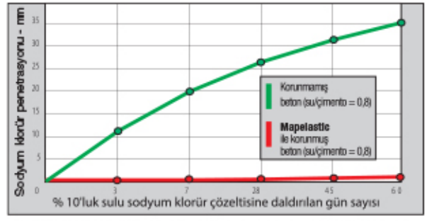
Şekil 3: Gözenekli betonda sodyum klorür penetrasyonuna karşı Mapelastic'in oluşturduğu koruma
